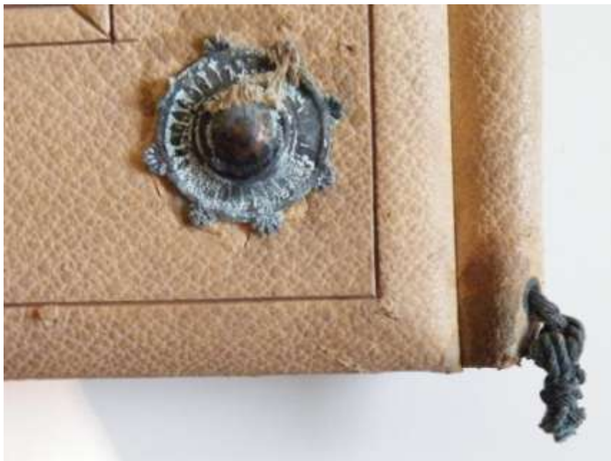
A savmarás okozta fémkorrózió képe az egyik csúszógomb felületén
